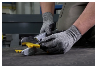
2. セグメントをベルト幅に調整
