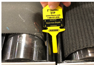
1. 専用のゲージで、ベルト間を測定
