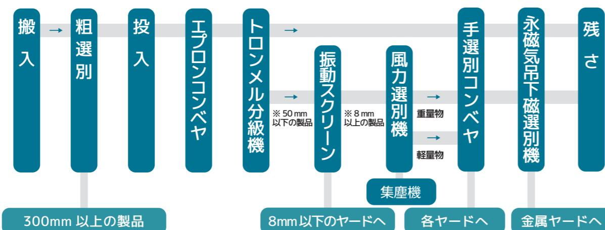
産業廃棄物選別設備の選別ライフ構成は共通点が多い一方で、選別後の処理工程により設備計画は大きく左右されます。
